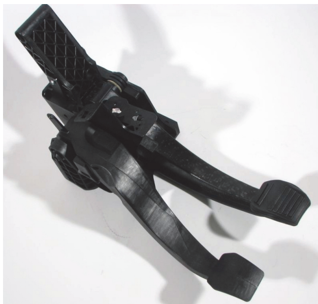
Figura 1 Caixa de pedais com pedal de freio em tecnologia híbrida de chapa de compósito de poliamida e pedal de embreagem
