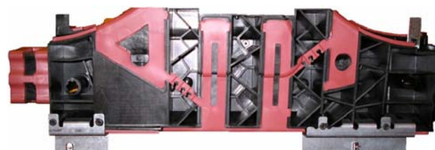
Bild 2 Spritzgegossenes Strukturinsert aus Durethan BKV 35 H2.0 (schwarz), komplettiert mit Schaumkörpern (rot) und Metallteilen.
