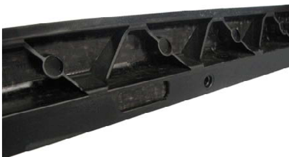
Bild 2 Ausschnitt der Verstärkung im U-Profil aus Organoblech im Untergurt
