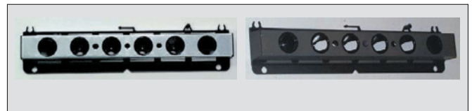
Bild 6: Versuchsteile aus verzinktem Blech (links) bzw. mit Granocoat
