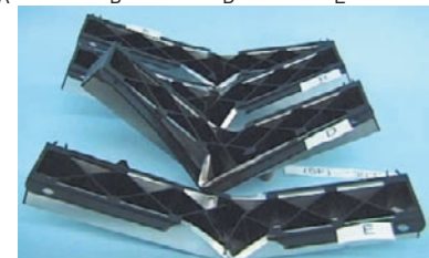
Bild 8: Ergebnisse nach Fallversuchen am Erlanger Träger [6]
