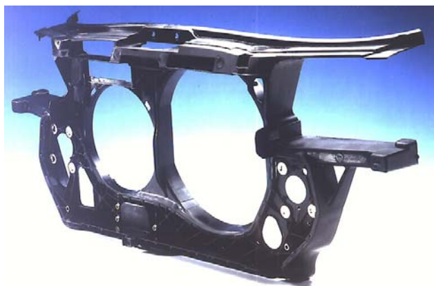
Bild 1 Das Frontend des Audi A6 besteht aus einer Hybridkonstruktion, einem Materialverbund aus Metall und glasfaserverstärktem, elastomermodifiziertem Polyamid 6.
