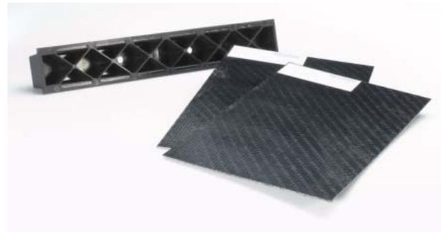
Bild 1: Organobleche mit Versuchsträger
